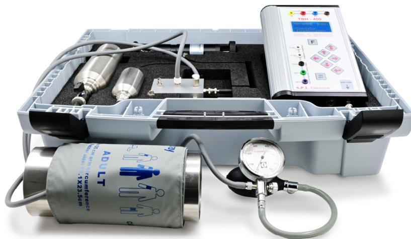
**Prüfgerät zur Funktionsprüfung von medizinischen Thermometern (DIN EN ISO 80601-2-56), Herzzeitvolumen-, invasiven (IEC 60601-2-34) und nichtinvasiven Blutdruck-Geräten (IEC 60601-2-30)**
